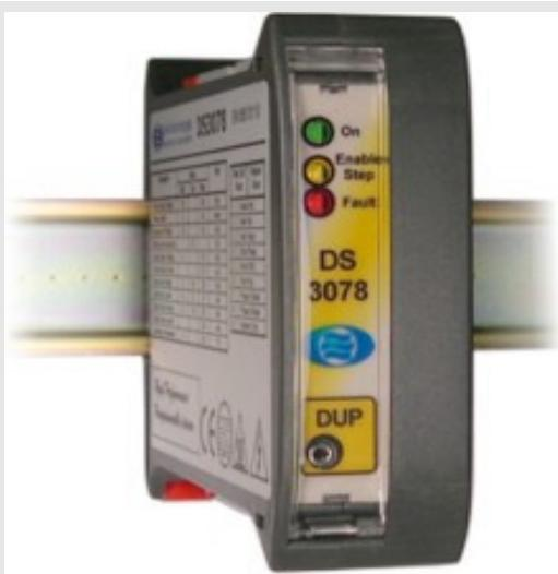
... mit industrietauglicher Schrittmotorsteuerung Typ LAM DS3078 und Applikationssoftware VPC-xxx ...
