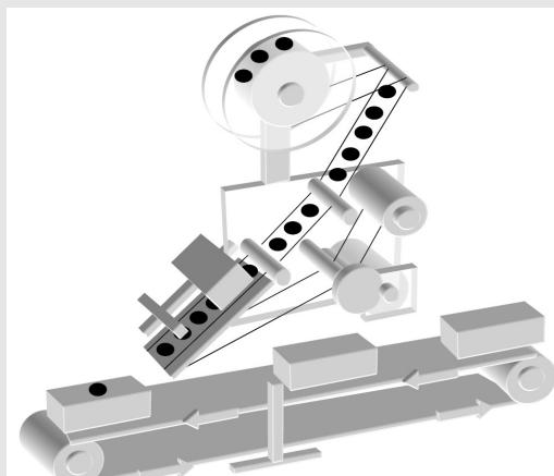
... für die Automatisierung von Etikettenabspendern. Maximale Abspendegeschwindigkeiten: G150: bis zu ca. 50m/min\* G280: bis zu ca. 75m/min\*\*
